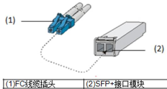
图4-33 FC 线缆和接口示意图
