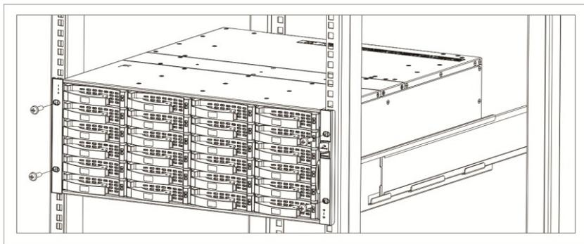
图4-12 安装 SPU 示意图
