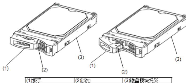
图6-14 3.5 英寸磁盘模块示意图
