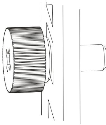
图8-6 拇指螺钉错误安装示意图（二）
