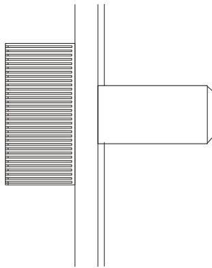
图8-4 拇指螺钉与方孔条表面贴平
