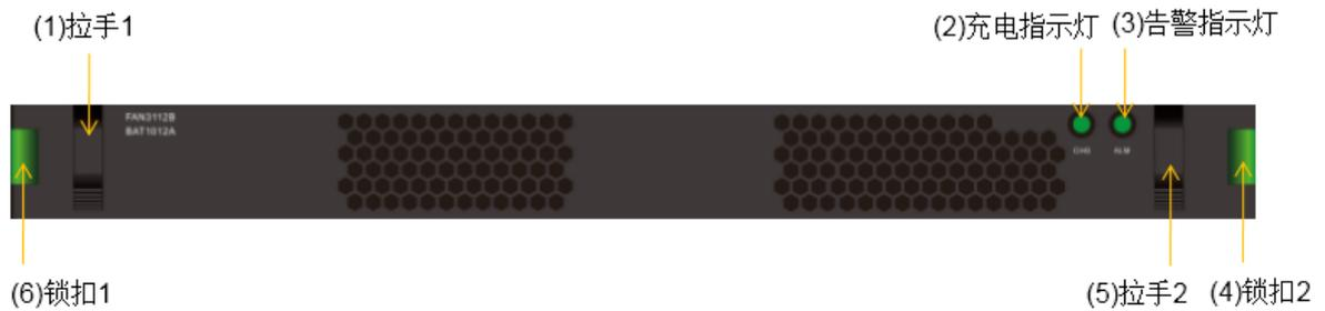
图3-4 风扇模块+电池模块正视图
