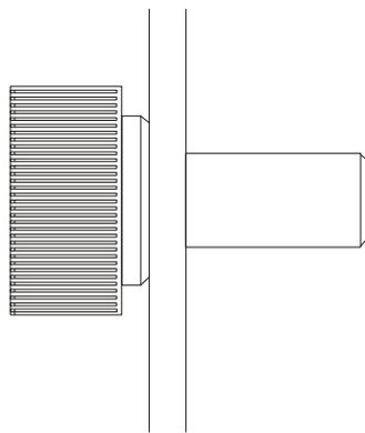
图8-7 拇指螺钉错误安装示意图（三）
