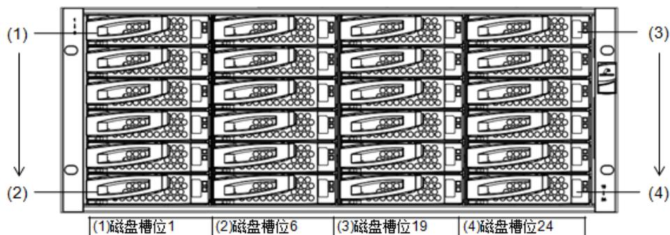
图6-15 SPU/DSU2624 磁盘槽位编号示意图
