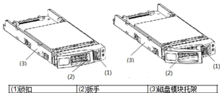
图6-10 2.5 英寸磁盘模块示意图
