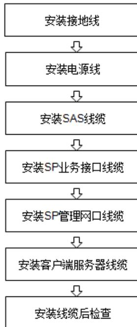
图4-19 线缆安装流程示意图
