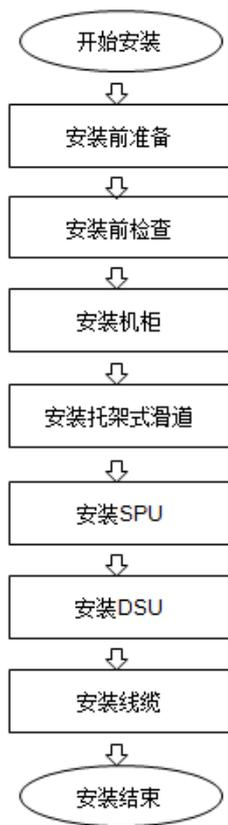
图4-2 存储设备的安装流程示意图
