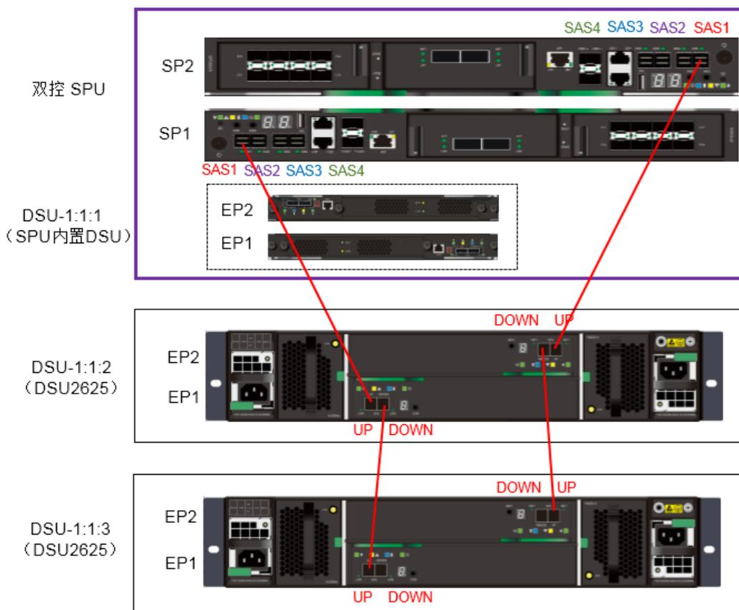
图4-31 SAS 线缆安装示意图
