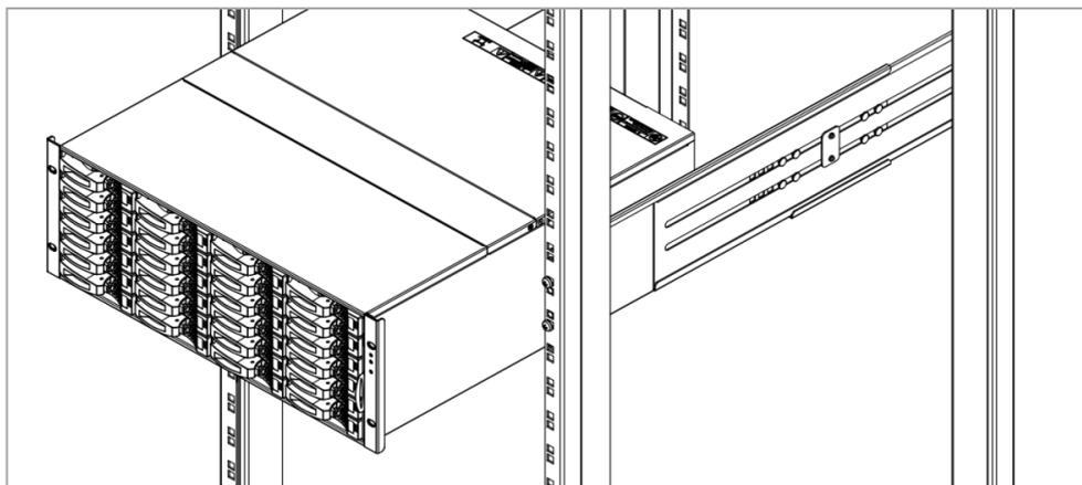
图4-14 安装 DSU 示意图
