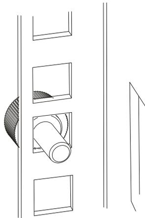
图8-5 拇指螺钉错误安装示意图（一）
