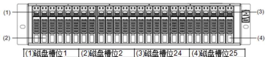
图6-11 DSU2625 磁盘槽位编号示意图
