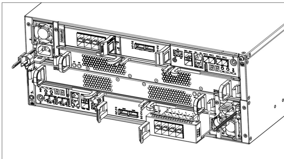
图6-9 安装/拆卸 IO 插卡示意图
