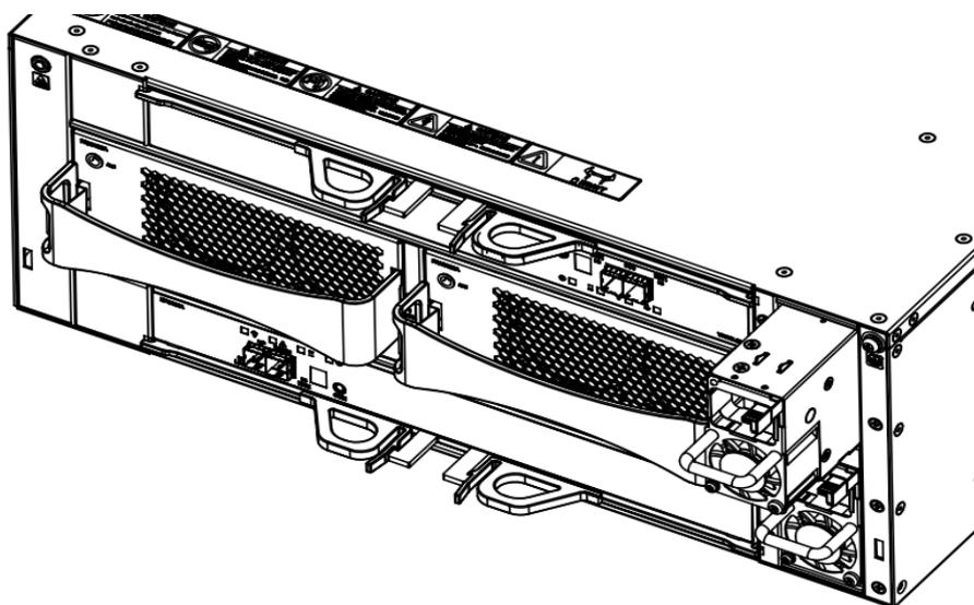
图6-4 安装/拆卸 DSU2624 电源模块示意图
