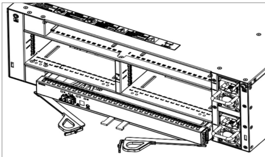
图6-3 安装/拆卸 DSU2624 EP 示意图
