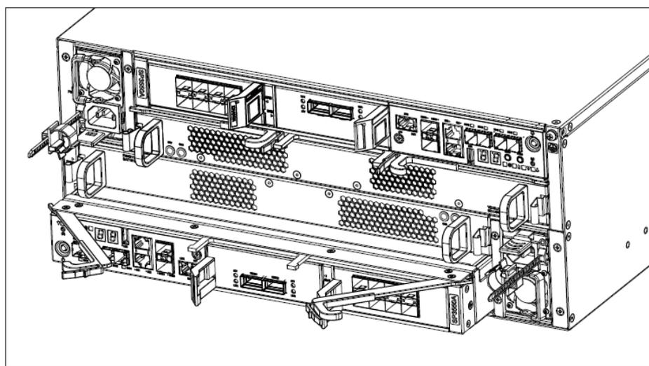
图6-1 安装/拆卸 SP 示意图
