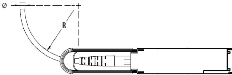
图4-30 AOC 光缆弯曲半径示意图
