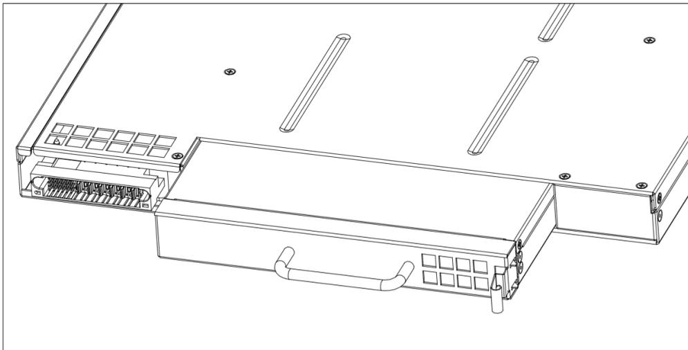
图6-6 安装/拆卸电池模块示意图
