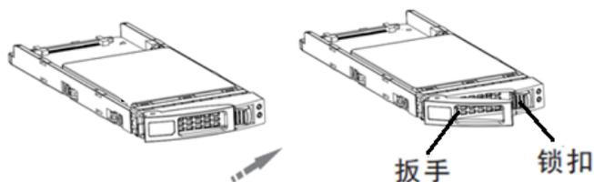
图6-12 安装 2.5 英寸磁盘模块示意图（一）
