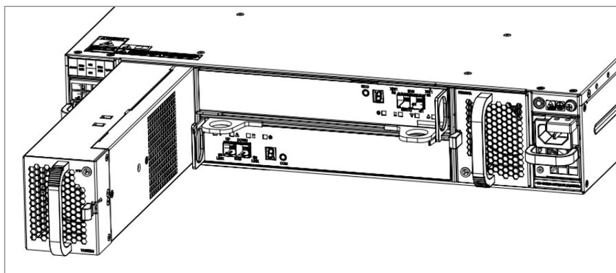
图6-7 安装/拆卸 DSU2625 风扇模块示意图
