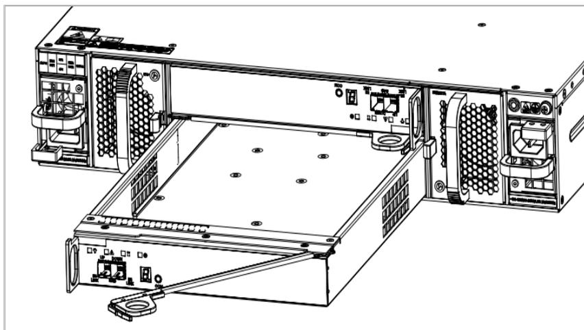
图6-2 安装/拆卸 DSU2625 EP 示意图
