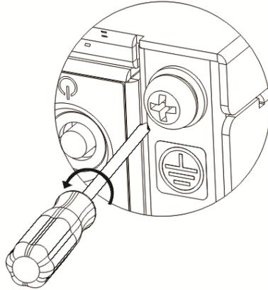
图4-21 松开设备接地端子的螺钉示意图
