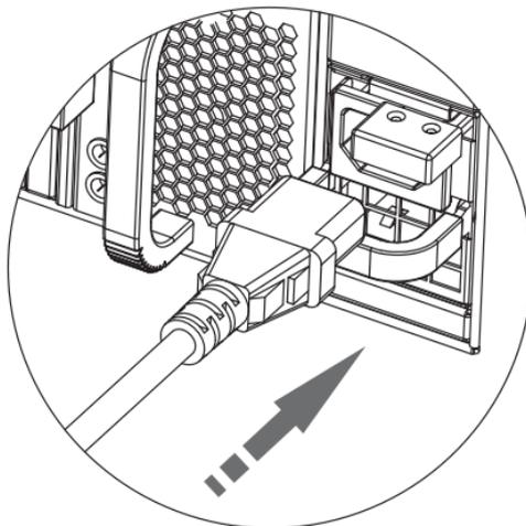
图4-25 安装电源线示意图 (二)
