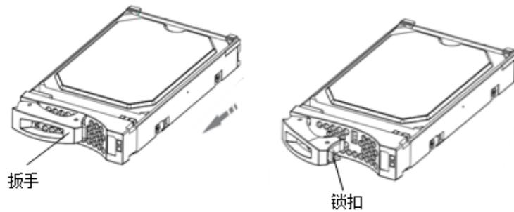
图6-16 安装 3.5 英寸磁盘模块示意图（一）
