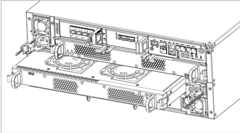
图6-5 安装/拆卸 SPU 风扇模块+电池模块示意图
