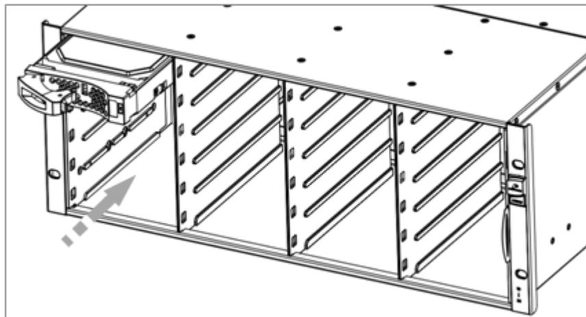
图6-17 安装 3.5 英寸磁盘模块示意图（二）
