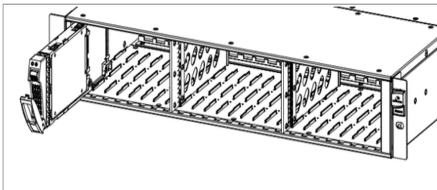
图6-13 安装 2.5 英寸磁盘模块示意图（二）
