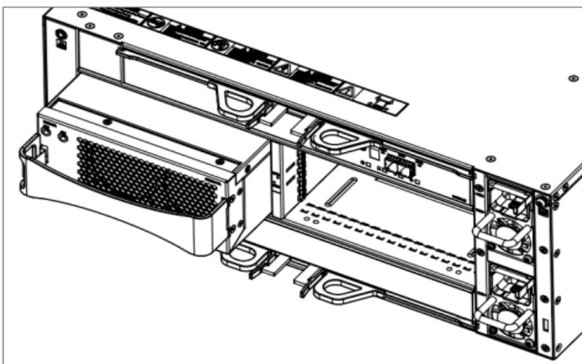
图6-8 安装/拆卸 DSU2624 风扇模块示意图
